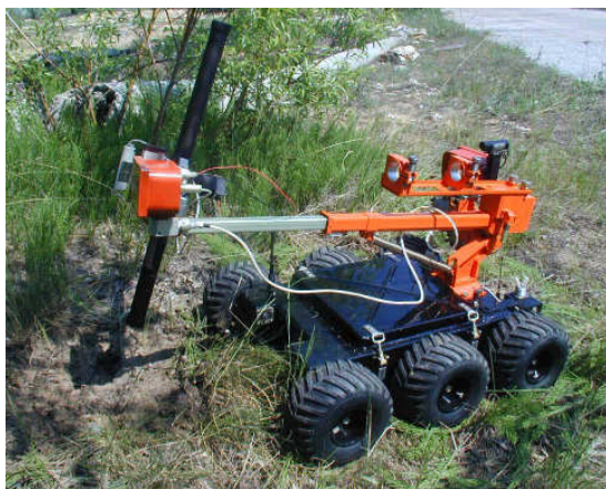
Рис. 2. Мобильный робототехнический комплекс сверхлегкого класса «Вездеход-ТМЗ» (на колесном ходу)
