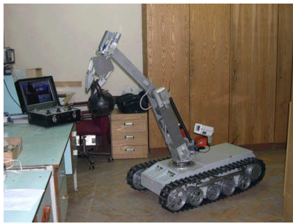
Рис. 3. Мобильный робототехнический комплекс легкого класса «Варан» (на гусеничном ходу)
